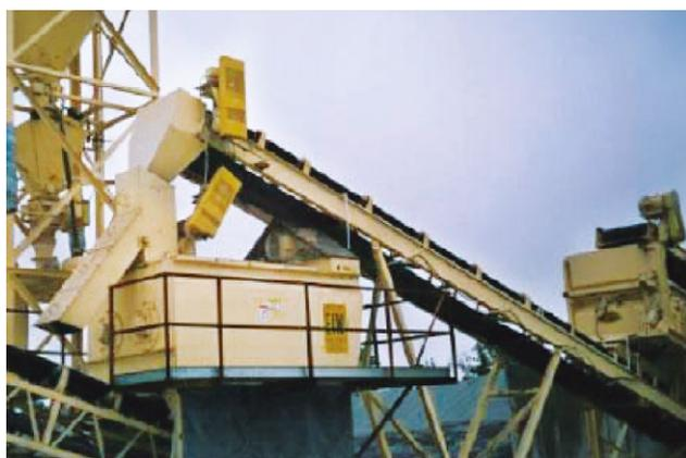
Figura 29. Mescolatore forzato di calce idrata e aggregato secco in South Carolina (USA) [145].
